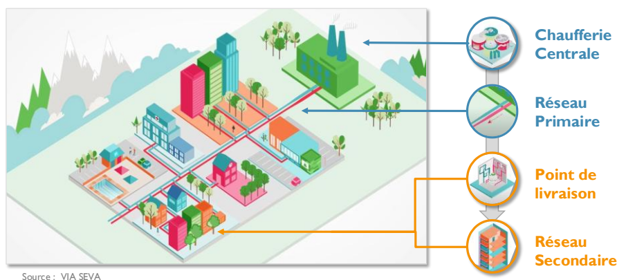
Figure 2 : Schéma de fonctionnement d'un réseau de chaleur (Source : Via Sèva)
