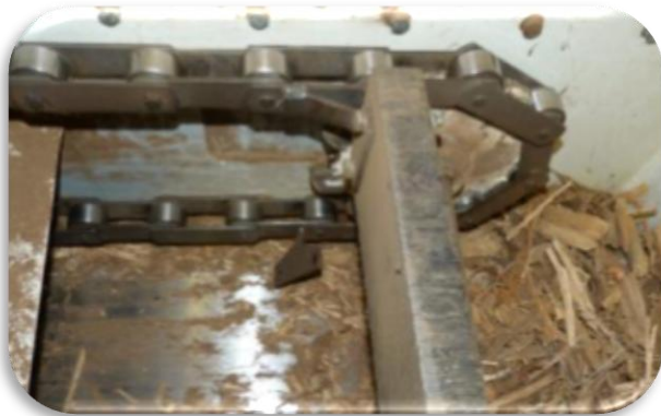
Crédit : Usure d'un convoyeur - Trifyl
